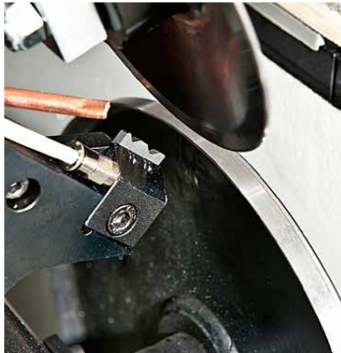
Versione per lavorazione automatica di 2 bordi raggiati con selezione da HMI. Microregolazioni con assi CN (opt).
