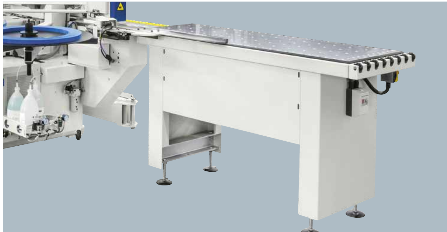
Movimentare abilmente i pannelli nella zona di carico è semplice e veloce con il banco a velo d'aria (opt).
