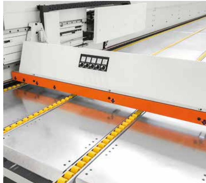
Introduttore manuale M+ per introdurre agevolmente e senza errori i pannelli ortogonalmente al senso di avanzamento fino a dimensioni 2.600 mm (opt).
