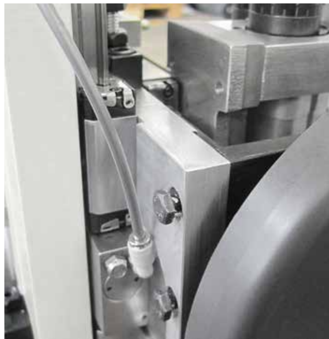
Kit Nesting lock che blocca istantaneamente il movimento verticale di copiatura nel caso di presenza del foro realizzato con ciclo nesting (opt.).
