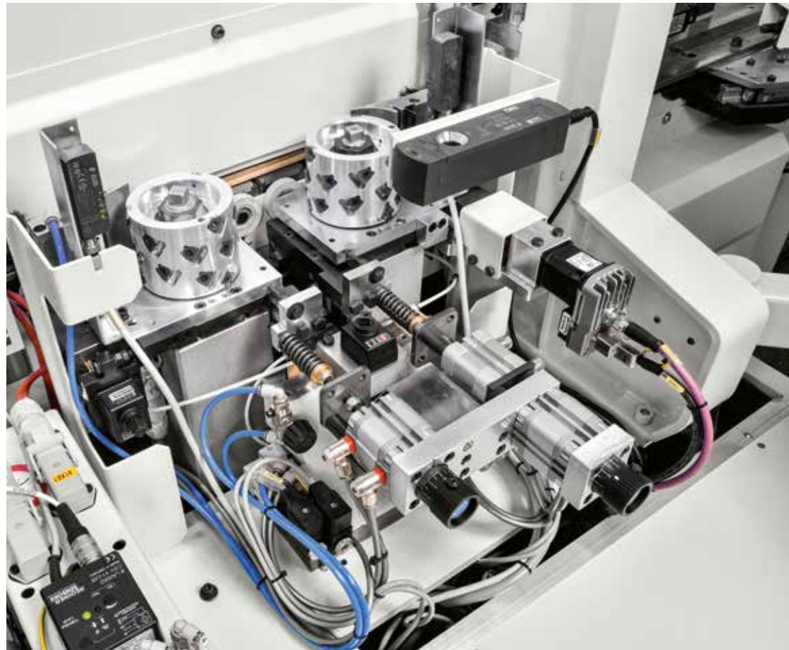
Sezione di taglio regolabile da HMI con micro regolazioni con assi a CN del primo copiatore e della guida in entrata (opt. easy size plus)
