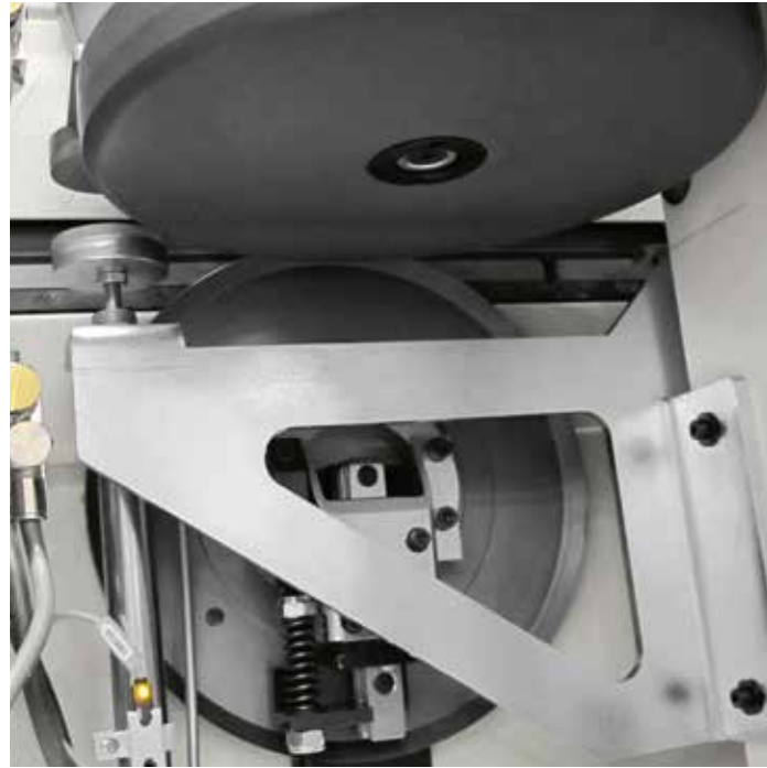
Sistema di controcopiatura aggiunta a disco di grande diametro nel caso di lavorazione di pannelli con ridotto spessore con tendenza a piegarsi (opt.).
