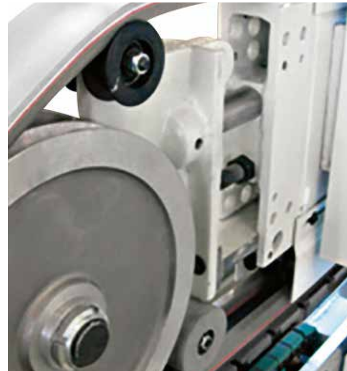
Pressore superiore a cinghia, con movimento verticale automatico da HMI a seconda dello spessore pannello.
