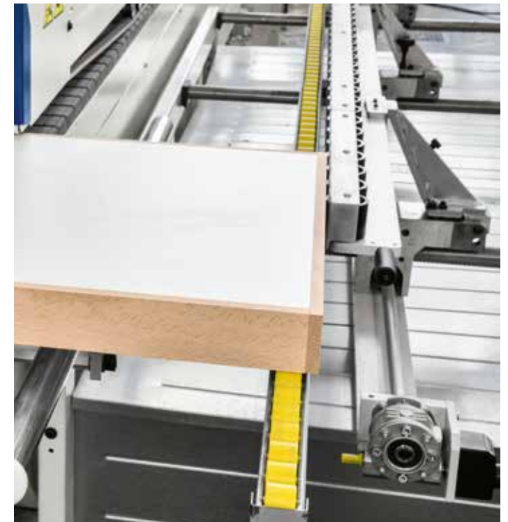
Spalla di contrasto per pannelli di piccole dimensioni e lavorazione massello (opt).
