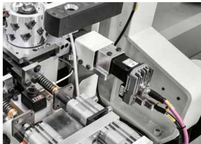
Sezione di taglio regolabile da HMI con micro regolazioni con assi a CN del primo copiatore e della guida in entrata (opt. easy size plus)
