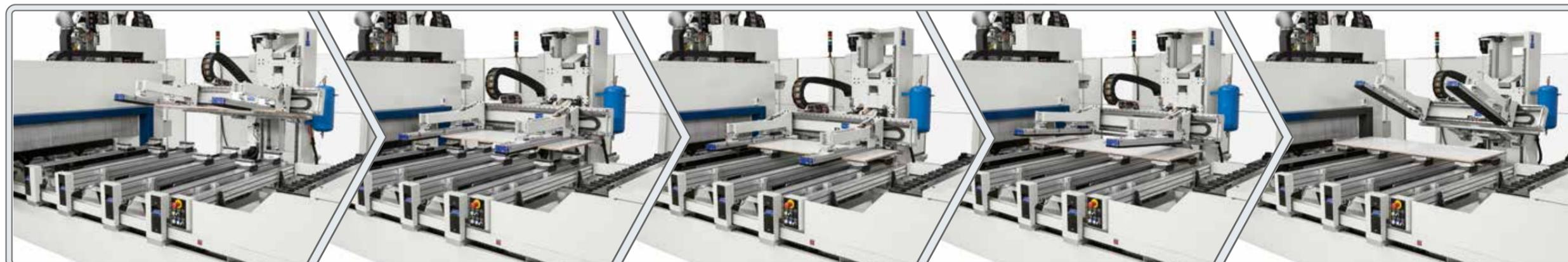
Il braccio flessibile di Cargo permette il carico e lo scarico continuo dei pezzi in tempo mascherato, mentre la macchina esegue la lavorazione nell'area opposta.
