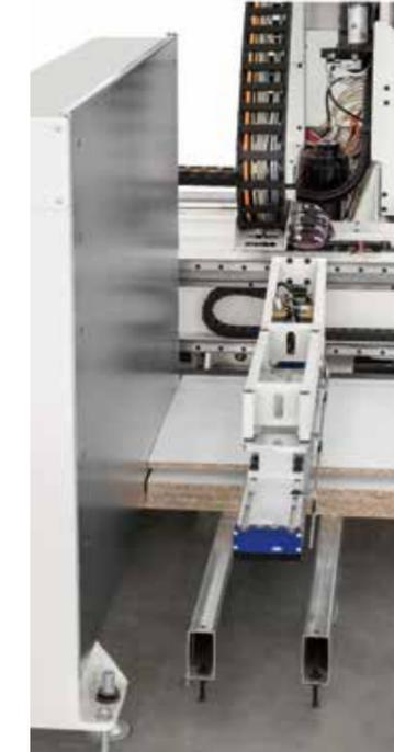
Massima precisione di posizionamento sul piano di lavoro grazie al sistema di pre-allineamento del pannello direttamente sulla pila di carico.
