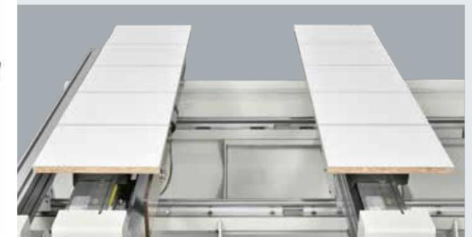
*Da un solo pannello si possono ricavare più elementi e riposizionarli in automatico per eseguire tutte le lavorazioni necessarie senza interrompere mai il ciclo produttivo; al termine i pezzi vengono riportati nella posizione iniziale per facilitare lo scarico dal piano di lavoro.*
