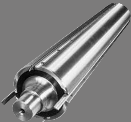
Albero monoblocco con coltelli tipo "Tersa" La struttura monoblocco in acciaio garantisce alta stabilità anche in presenza di forti carichi dinamici. Il bloccaggio automatico dei coltelli ad opera della forza centrifuga conferisce sicurezza e precisione in lavorazione. Il sistema privo di viti di fissaggio rende estremamente rapida la sostituzione dei coltelli.
