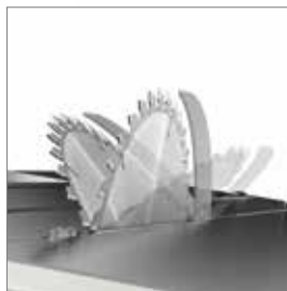
Doppia inclinazione lama \pm 46^\circ .
