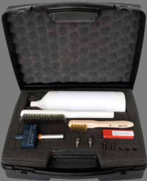
Valigetta di manutenzione per albero "Xylent" Completa di: - 1 flacone di liquido detergente/ sgrassante per la pulizia delle resine - 1 chiave dinamometrica tarata - 2 bit Torx - 10 inserti - 5 viti - 1 spazzola con setole in ottone per pulire l'albero con inserti montati - 1 spazzola con setole in acciaio per pulire le sedi degli inserti
