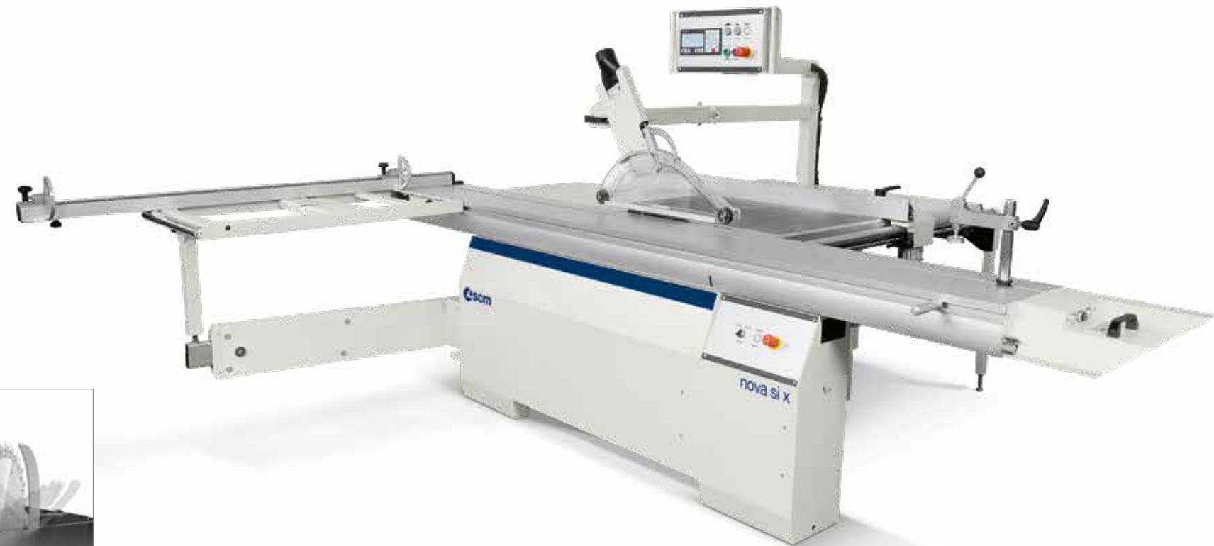
Doppia inclinazione lama \pm 46^\circ .
