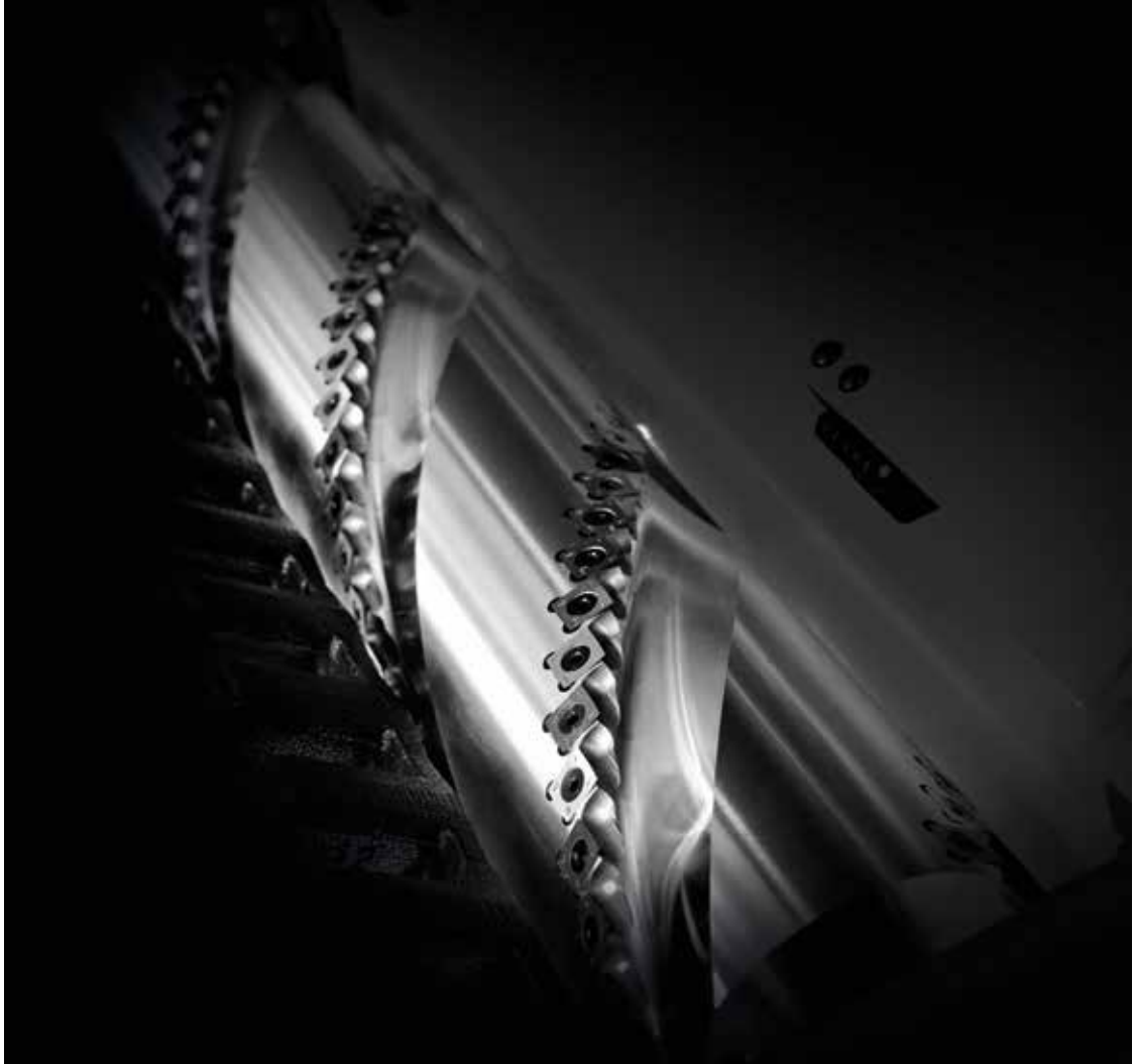
Albero pialla "Xylent" con coltelli disposti a spirale Le 3 spirali di coltelli garantiscono una eccezionale finitura. Permette lavorazioni alla pialla in estrema silenziosità . Migliora l'aspirazione grazie alla produzione di trucioli di dimensione molto ridotta . Aumenta la durata dei coltelli, con la possibilità di poterne sfruttare i quattro lati taglienti.
