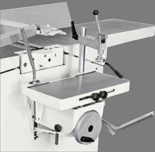
Cavatrice in ghisa Le cave, mortase e giunzioni ad incastro sono facilmente eseguibili. La cavatrice è completa di cappa d'aspirazione di diametro 120 mm e mandrino da 16 mm.
