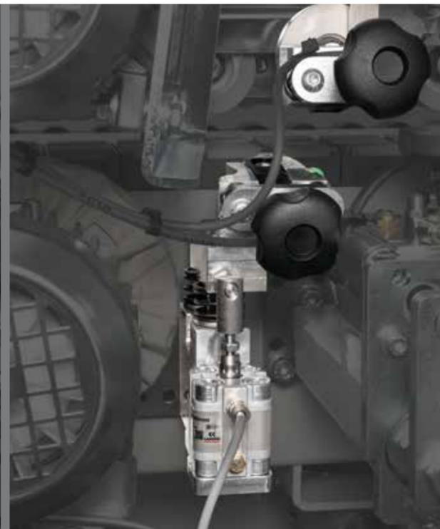
In alternativa, il gruppo raschiacolla è disponibile anche con il nuovo sistema automatico di inserimento e disinserimento con attuazione pneumatica (me 40/me 35), gestito dal controllo elettronico.
